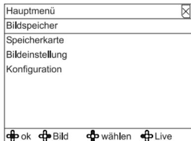
Um das Hauptmenü aufzurufen, Eingabetaste drücken oder in der untersten Zeile des Monitors mit der Steuertaste Menü auswählen.
